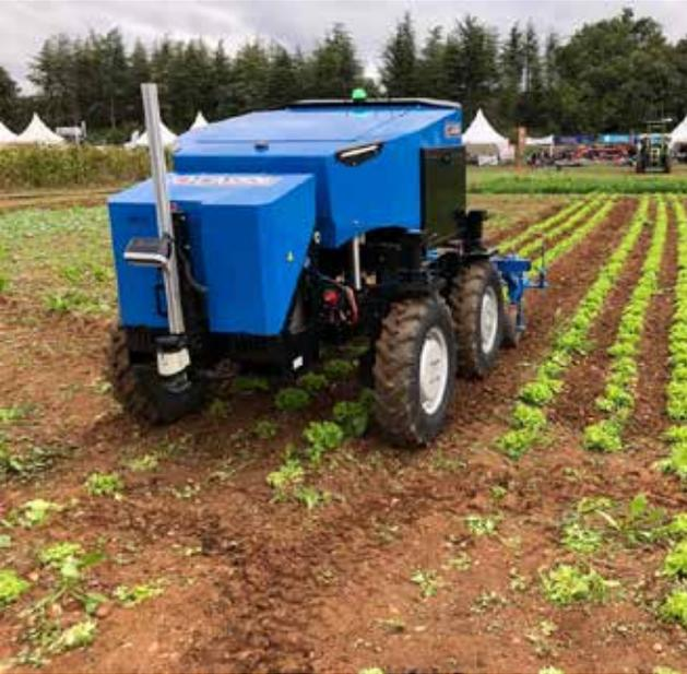
ANATIS vous assiste dans votre quotidien en réalisant en totale autonomie les travaux de désherbage mécanique. Il est 100% électrique et dispose d'un pack de batteries interchangeables, pour une plus grande autonomie. La polyvalence de ce robot collaboratif, grâce à un attelage trois points arrière standard, lui permet de réaliser différents travaux avec différents outils. L'expérience du constructeur Carré dans le désherbage mécanique est un gage d'efficacité.
