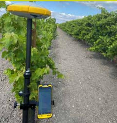
Grâce aux cannes d'arpentage piétonnes, profitez d'une solution mobile et robuste pour effectuer des relevés ou des cartographies de vos parcelles, créer des lignes de guidage ou retrouver des bornes cadastrales. Bénéficiez d'une précision submétrique à centimétrique en fonction de la correction choisie. Les cannes d'arpentage sont disponibles sous un univers Android ou Windows selon le logiciel utilisé.
