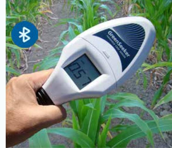
Le capteur Trimble® GreenSeeker 2® est un appareil de mesure mobile facile à utiliser qui évalue la vigueur d'une culture. Les lectures des indices NDVI par le GreenSeeker 2® sont utilisées pour prendre des décisions concernant la quantité d'azote à appliquer à votre culture, ce qui entraîne une utilisation plus efficace de vos engrais. Optimisez vos tours de plaine avec la pince GreenSeeker 2® et sa compatibilité bluetooth.
