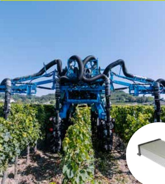
Le calculateur Field-IQ ISOBUS sait s'adapter à votre machine en la transformant en ISOBUS. Paramétrable pour un pulvérisateur, un semoir, un distributeur d'engrais, etc. ce boîtier vous garantit la compatibilité ISOBUS de votre matériel. Il s'agit d'une alternative au changement de vos outils pour bénéficier pleinement et à moindre coût des avantages de cette technologie comme le contrôle de sections et la modulation de dose automatique.
