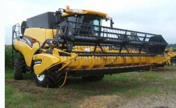
Insight est un système de gestion automatique de hauteur pour barres de coupe et cueilleurs de moissonneuses-batteuses et d'ensileuses.
