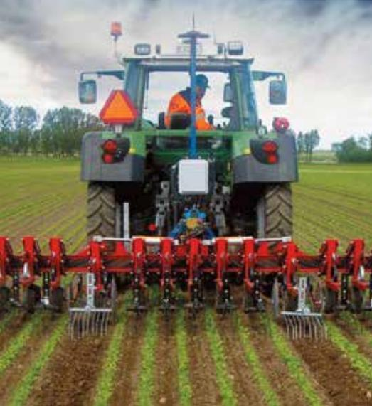
Guider le tracteur c'est bien, guider l'outil c'est encore mieux. Pour vos travaux nécessitant une grande précision ou dans des conditions de dévers, guider tracteur et outil est la meilleure solution. Le système TrueTracker calcule et positionne précisément l'outil dans les coteaux, les trajets en courbe et toutes variations de terrain.
