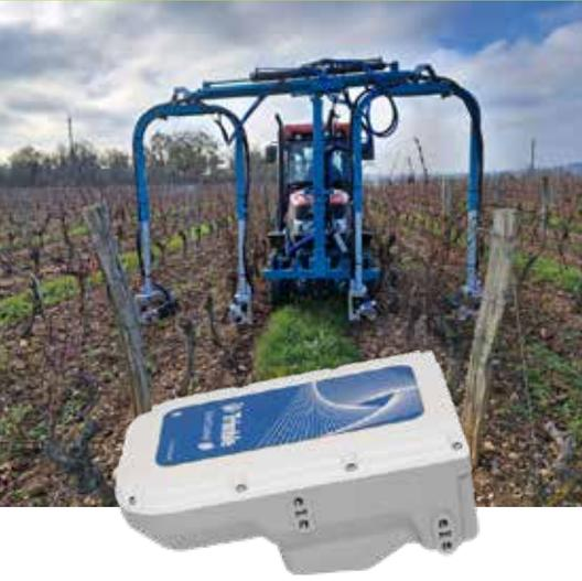
Le capteur WeedSeeker 2 détecte les végétaux et applique le produit grâce à sa technologie optique avancée et à sa puissance de traitement. Lorsque le capteur passe au-dessus de l'adventice, il envoie un signal à la buse de pulvérisation afin de délivrer l'herbicide avec précision sur la plante ciblée. La quantité de produit appliqué à l'hectare est réduite jusqu'à 90%.
