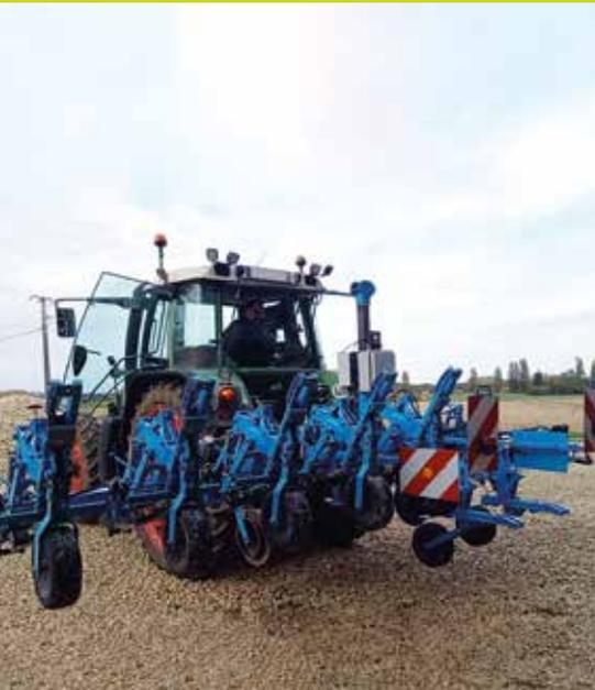
Le système Rel'Bine permet un relevage complet des éléments bineurs. Contrairement aux systèmes d'origine, le Rel'Bine sort complètement l'élément de la culture et protège donc beaucoup mieux les végétaux des blessures. Les fenêtres d'interventions du binage sont plus longues. Le binage peut donc s'opérer à un stade plus avancé de la culture jusqu'à une couverture complète du sol dans les bouts et les pointes. Ce produit breveté s'intègre facilement sur les bineuses existantes.
