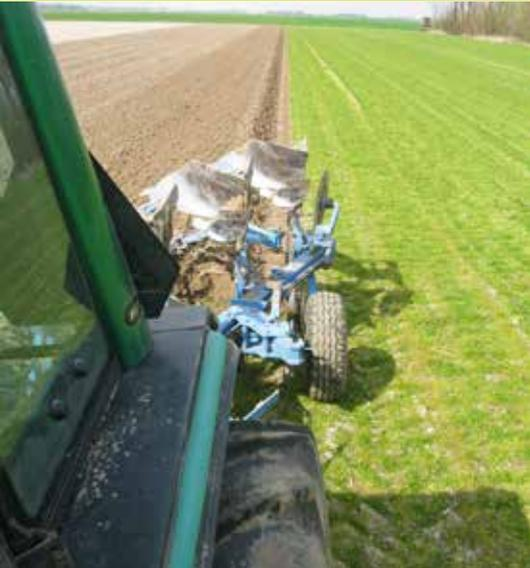
Le système de guidage GeoPlough a été conçu spécialement pour les charrues dans le but d'obtenir des sillons droits et des bords de champs bien finis. Il fonctionne sur tous les types de charrues à largeur variable, indépendamment du nombre de socs. Grâce au RTK, GeoPlough propose une précision absolue.
