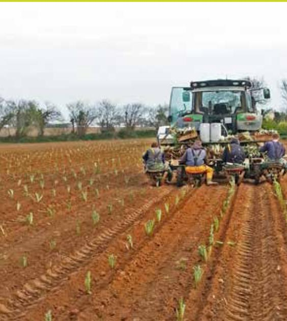
Le système P2 est parfaitement adapté aux planteuses maraîchères à soc : le positionnement du plant au sol par un jet de peinture et la plantation sont réalisés en un seul passage, évitant ainsi l'opération fastidieuse de traçage. Vantage AM peut également automatiser votre repiqueuse à pinces, becs ou éjecteur. Chaque élément de la planteuse est géré indépendamment, assurant ainsi un alignement parfait des plants dans les deux directions et en aller-retour.
