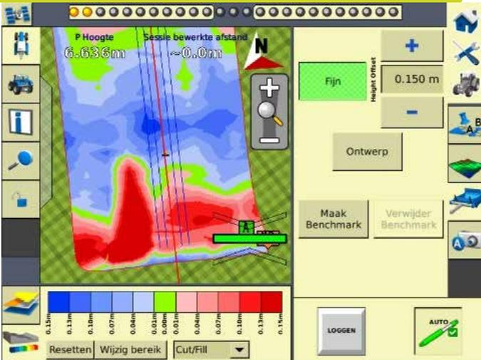
Le système FieldLevel II fournit une solution GNSS complète pour le relevé, la conception et le nivellement de surfaces de champ, garantissant ainsi une gestion optimale de l'eau.
