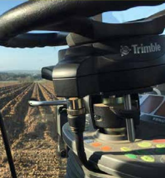
Le système EZ-Pilot Pro fournit un guidage de haute précision sur tous les tracteurs et moissonneuses-batteuses. Le véhicule peut prendre la ligne de guidage suivante en marche arrière, l'autoguidage restant engagé. Grâce à ce guidage «mains libres», vous pourrez effectuer vos opérations beaucoup plus sereinement.
