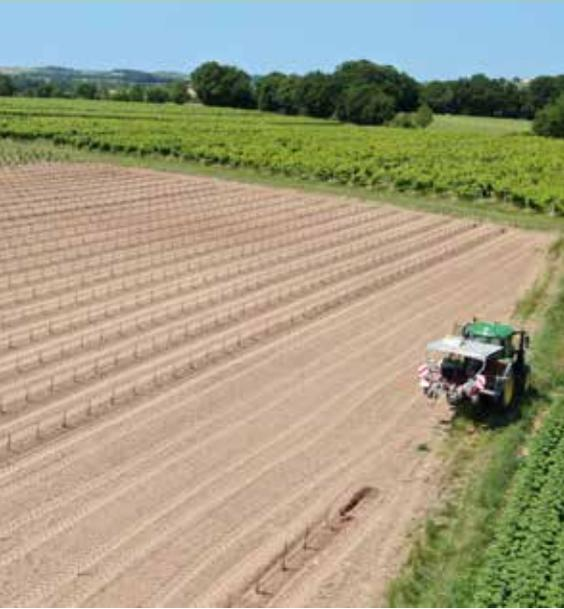
Vantage AM pilote par GNSS votre planteuse à marteau (Léger, Fontan, etc.), de type Wagner ou de type Clemens : pose du plant ou du marquant, mais aussi selon l'équipement présent, gestion du coulisseau latéral, de l'arrosage, de la mise à plat machine... L'arpentage de la parcelle et la création du plan de plantation peuvent être réalisés en amont afin de connaître précisément la surface et le nombre de plants.
