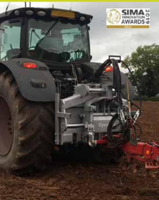
Pour guider votre outil, un actionneur est nécessaire. Celui-ci, parfois monté d'origine sur votre outil (coulisseau, essieu directeur, timon articulé...), peut être utilisé pour le guidage automatique. Pour les machines non équipées, Vantage AM propose plusieurs types d'actionneurs correspondant au mieux à votre besoin : vérin stabilisateur, coudre ou translateur.
