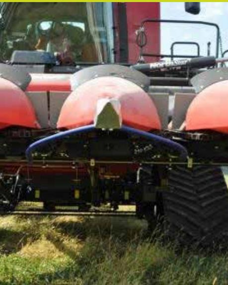
Le système Truesight permet d'autoguidé les moissonneuses-batteuses dotées d'un cueilleur en prenant comme repère la culture en cours de récolte. Le capteur est positionné de manière à détecter deux rangs, augmentant ainsi la précision du positionnement.
