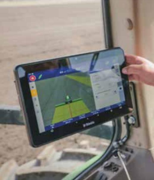
La GFX-1260 de Trimble est une console de 30,5 cm polyvalente et évolutive. Compatible autoguidage et contrôle de sections, elle saura vous accompagner dans vos travaux d'épandage, de pulvérisation et de semis. Sa fonction ISOBUS vous permettra de piloter plusieurs outils avec un seul écran. Son fonctionnement sous Android la rend intuitive et conviviale.
