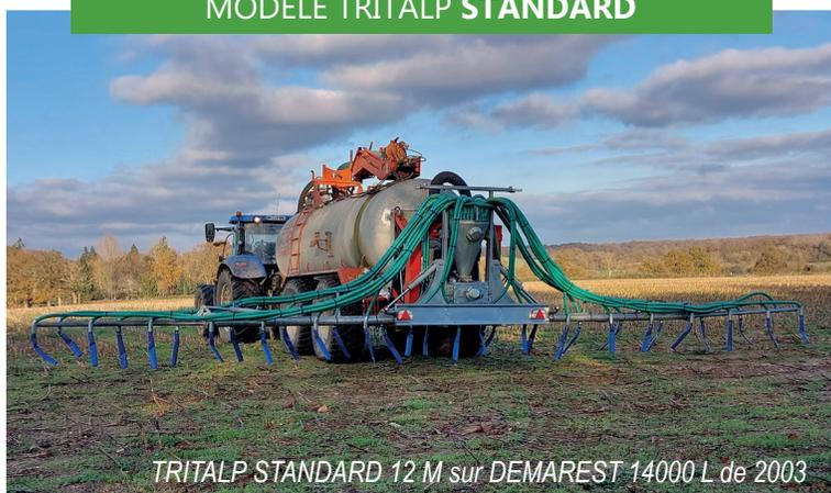
Le modèle STANDARD est une rampe à pendillard d'une largeur de 6 à 12 m adaptable sur toutes les tonnes à lisier, avec ou sans relevage.
