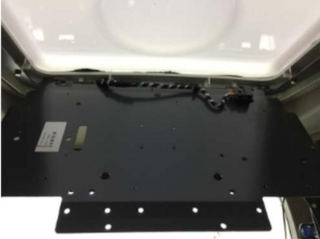
2. Retirer le plateau de montage de l'antenne. Centrer le contrôleur de guidage sur le plateau.
