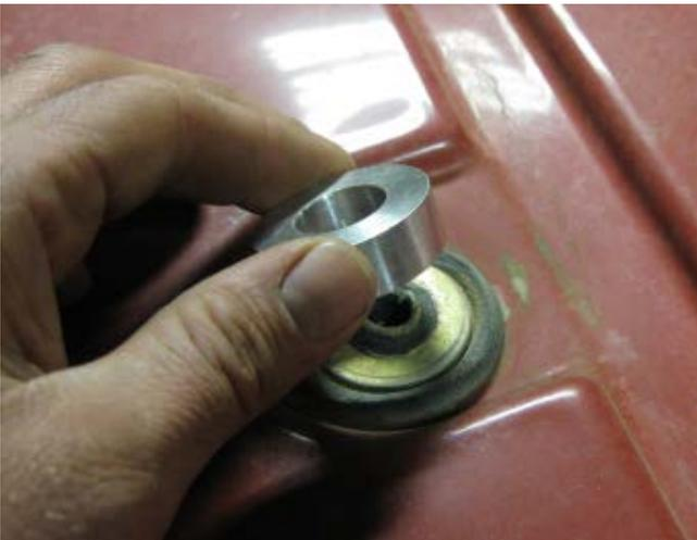
7. Localiser les boulons plus longs fournis à utiliser pour fixer la barre. Placer la rondelle d'origine et la rondelle plus grande fournie sur le boulon.
