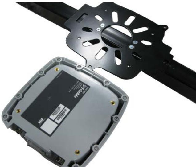
4. Poser la plaque de montage avec la barre fixée sur la partie supérieure. Fixer la plaque au contrôleur de guidage avec les quatre boulons de 6 mm et les rondelles de blocage fournis. Serrer les boulons. Prendre garde à ne pas trop serrer les boulons car cela pourrait entraîner des dommages.
