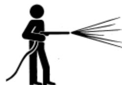
Réglez la pression du tuyau aussi bas que possible et pulvérisez à un angle compris entre 45 ° et 90 °. Maintenez la buse du jet de vapeur loin de la machine, à la distance recommandée par le fabricant.
