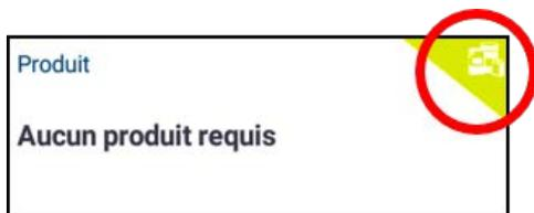
***REMARQUE** – si l'outil sélectionné n'applique pas de produit (par exemple, outils de labourage ou de drainage souterrain), aucun produit n'apparaîtra sur la vignette Produits.*
