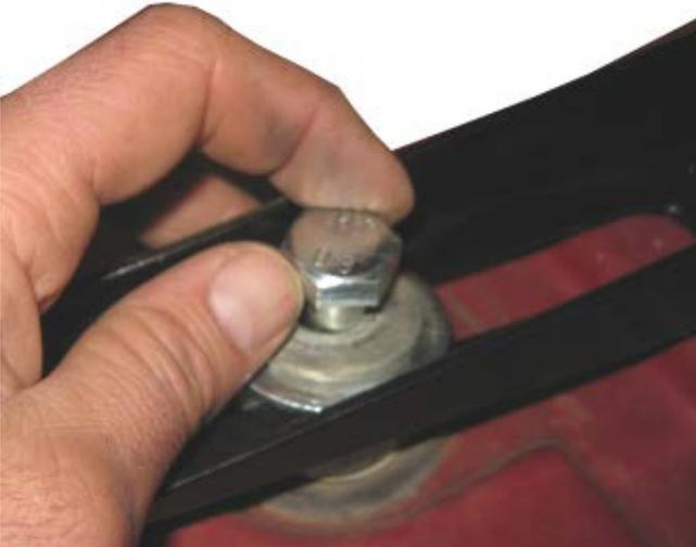
9. Insérer le boulon de l'autre côté de la cabine. Centrer la barre sur la cabine à l'aide d'un ruban de mesure. Puis serrer les boulons.
